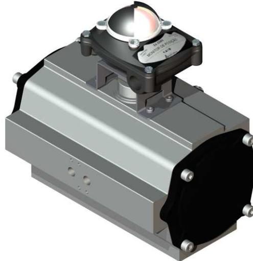
Fim de Curso Padrão INTERATIVA Modelo IA-210N é indicado para monitoramento de posição da válvula indicando se a mesma está totalmente aberta ou fechada. Possui 02 chaves mecânicas tipo SPDT. Possui 02 conexões elétricas 1/2" NPT (Fêmea). Possui haste e suporte em aço inoxidável para acoplamento mecânico conforme norma VDI/VDE 3845 para montagem direta em atuadores padrão Namur. Terminal de bornes de 8 pontos. Grau de proteção IP-67. Temperatura de trabalho de -20°C à +80°C
